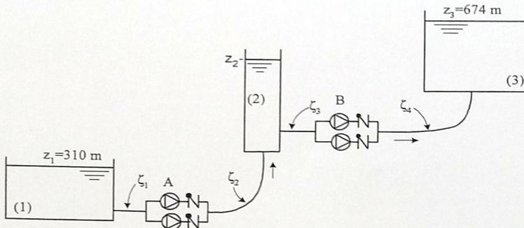
Οι αντλίες του αντλιοστασίου Β είναι γεωμετρικά ομοιοί με αυτές του αντλιοστασίου Α, και όλες είναι 3-βάθμιες. Οι χαρακτηριστικές καμπύλες των αντλιών του αντλιοστασίου Α, στις  $n = 1500$  rpm που λειτουργούν, είναι:
